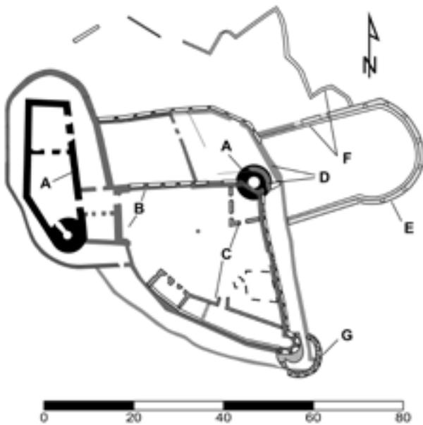
Abb. 2: Kynast/Chojnik. Räumliche Entwicklung der Burg: A - 14 Jh., B - 15.- Mitte des 16. Jh., C - 3. Viertel des 16. Jh., D - vor 1518, E - ca. 1518, F - 17. Jh., G - ca. 1650 (Bearbeitung: A. Łuczak).
