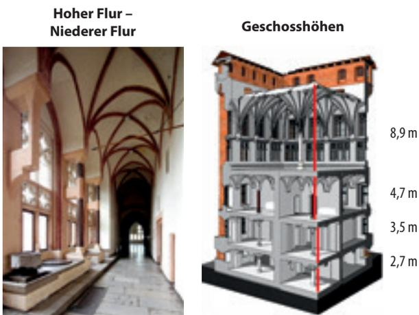
Abb. 2: Differenzierung der Raumhöhen im Hochmeisterpalast (Bearbeitung: Verfasser).
