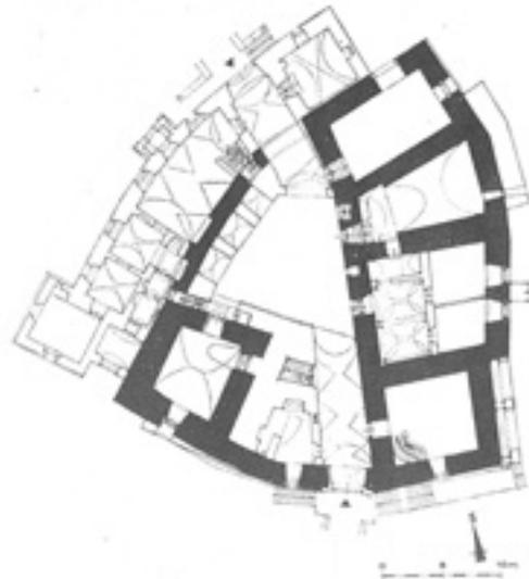
Abb. 20: Vrchotovy Janovice, Grundriss der Feste oder kleiner Burg (nach F. Kašička); schwarz - das Mauerwerk aus dem Mittelalter.
