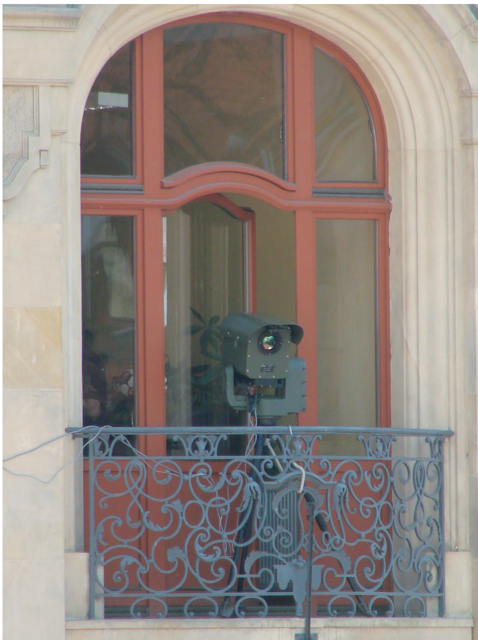
Fot. 1. Zabezpieczenie Strefy Kibica EURO 2012 — wrocławski Rynek; urządzenie do zdalnej detekcji Second-Side
