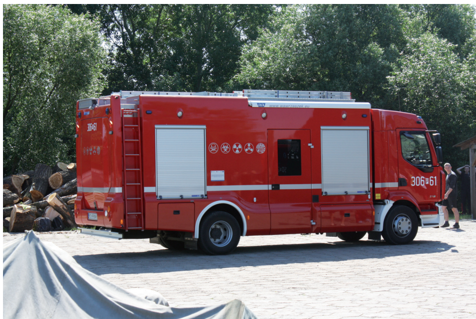
Fot. 3. Specjalistyczny samochód SRChem, przeznaczony do rozpoznania chemicznego (CBRN), wyposażenie Państwowej Straży Pożarnej
