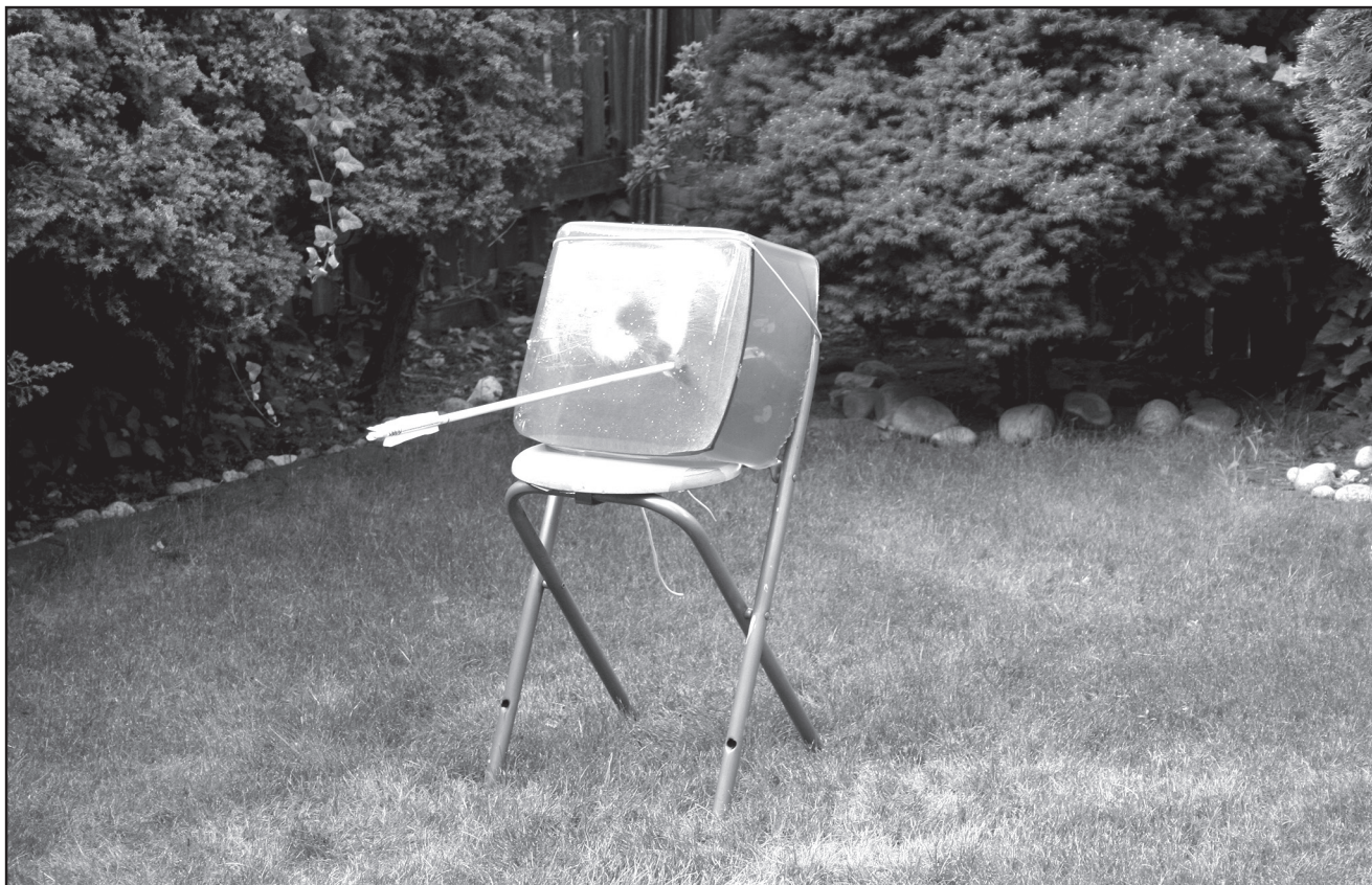
Ryc. 5. Blok żelu balistycznego z wbity strzałą. Fot. M. Łapa
